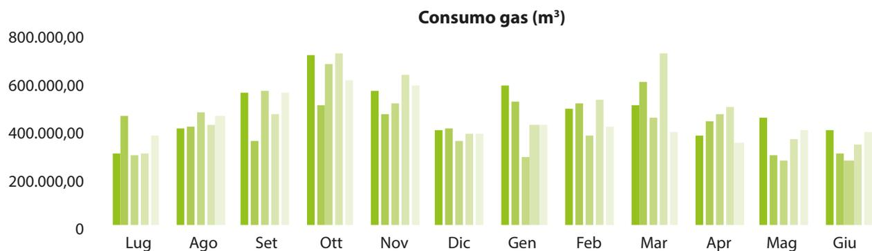
Fig. 4: Consumo mensile di gas naturale (caldaie a vapore ed impianti di riscaldamento) ■ 2018/2019 ■ 2019/2020 ■ 2020/2021 ■ 2021/2022 ■ 2022/2023
