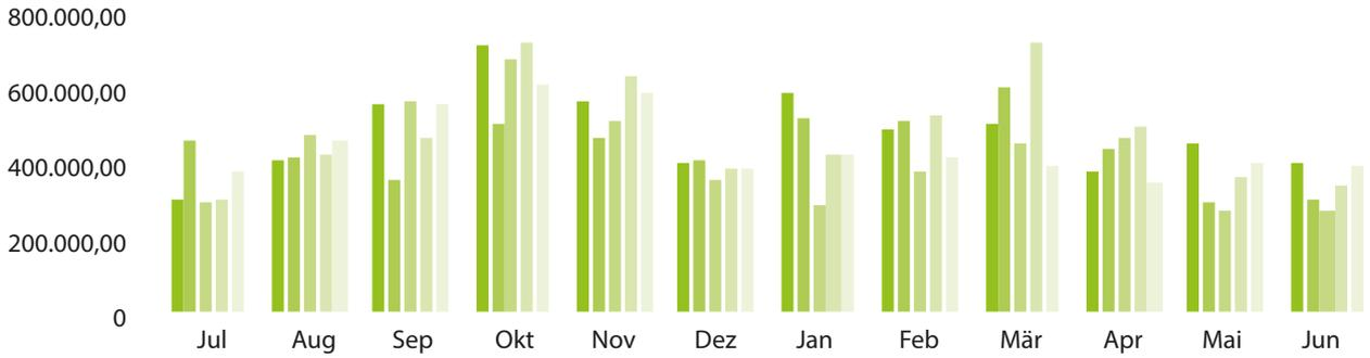
Abb. 4: Monatlicher Verbrauch von Erdgas (Dampfkessel und Heizungsanlagen)
